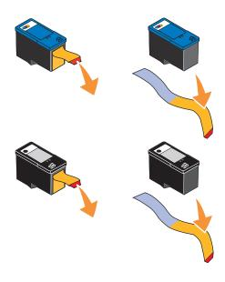
7 Coloque os novos cartuchos de tinta. Verifique se o cartucho de tinta preto ou fotográfico está seguro no suporte do cartucho à esquerda e se o cartucho de tinta colorido está seguro no suporte do cartucho à direita.
