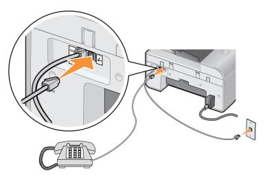
Conecte um telefone à impressora para usar a linha de fax como uma linha telefônica normal.
